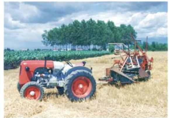
*LA MIETILEGA: Rivoluzionaria! La falciatrice, la grande ruota a pale ed il meccanismo per legare i "balz" in maniera uniforme permettevano, con un unico passaggio, di sostituire con una sola persona il lavoro che veniva altrimenti compiuto, con molta fatica, da diverse braccia.*
